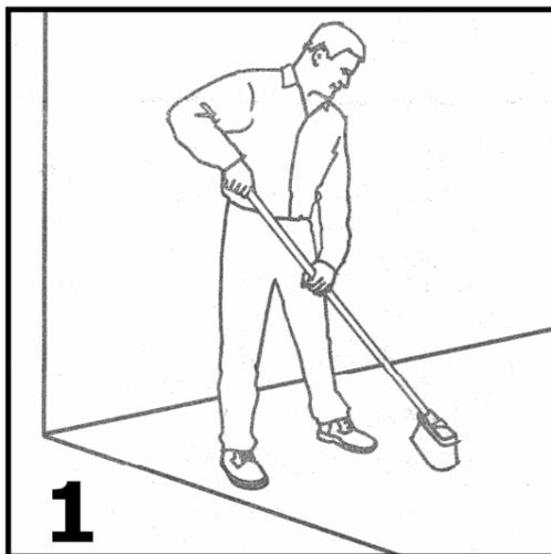
1 Floor or wall must be dry and free from dust and grease. Remove loose parts. Der Fußboden und/oder die Wand muss trocken-, staub und fettfrei sein (evtl. lose Teile entfernen). Nettoyez bien le sol ou le mur afin qu'il ne reste ni poussières, ni graisses, ni humidité. Otez tous les résidus. Vloer of wand moet droog, stof- en vetvrij zijn. Loszittende delen verwijderen.
