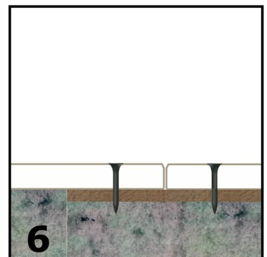
6 So for board 9,5 or 12,5 mm thick, 26 mm. long screws can be used. Für eine optimale Schallisolation dürfen die Verkleidungsplatten nicht direkt mit den nicht isolierten Fußboden-, Decken- oder Wandteilen in Verbindung gebracht werden. En cas de finition en plaques de placoplâtre de 9,5 ou 12,5 mm., prenez des vis d'une longueur de 26 mm. Voor plaatmaterialen van zowel 9,5 mm. als 12,5 mm. dikte kunnen dus schroeven van 26 mm. lengte gebruikt worden.
