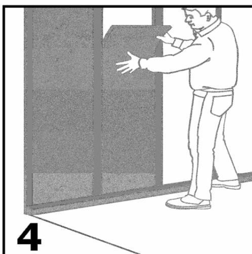
4 Place the flexible insulation between the strips. Die Isolationsplatten zwischen die Leisten klemmen. Kleber oder Kitt ist nicht nötig, da es keine offenen Nähte gibt. Placez ensuite les panneaux calés entre les languettes; il n'est pas nécessaire de les encoller. Isolatieplaten klemmend tussen de rachsels plaatsen. Verlijming is niet nodig.
