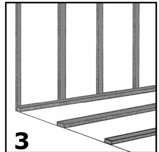
3 Place strips with a distance of 50 cm in between and press firmly. Use the narrow strips at the sides and around door frames. Die Leisten mit exakt 50 cm. Zwischenraum anbringen und gut andrücken. Placez les languettes tous les 50 cm. en appuyant fortement. Utilisez les languettes fines départ ou fin pour les coins ou les encadrements de portes ou fenêtre. Rachsels met 50 cm. tussenruimte plaatsen en goed aandrukken. Aan de kanten en bij deurposten de smalle begin-/eindrachsels gebruiken.
